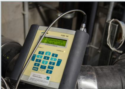
Mit dem FLUXUS® F601 lässt sich im Handumdrehen eine temporäre Durchflussmessstelle einrichten.
